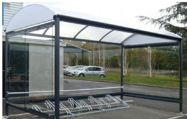
Exemple d'abri sélectionné d'une longueur de 4 m pouvant accueillir au maximum 10 vélos, en structure acier galvanisé avec un habillage en verre trempé « securit », et une couverture en polycarbonate alvéolaire traité UV.
